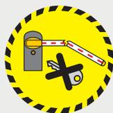
⚠ ¡ATENCIÓN! La operación de desbloqueo puede conllevar un potencial peligro para el usuario cuando, por cualquier motivo -mástil fijado mal a su alojamiento durante el montaje, mástil arrancado o roto debido a un accidente, etc.- los muelles en tensión ¡no garantizan más el equilibrio! Dichos muelles pueden provocar una brusca rotación del enganche del mástil y/o del propio mástil.
