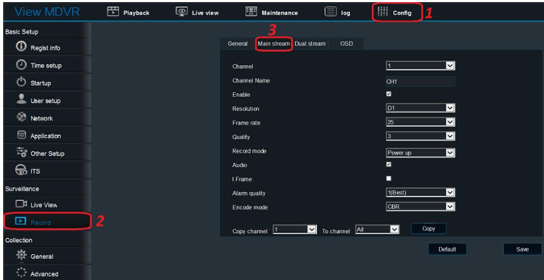
Como puede observar en Resolución tiene D1, ahí es donde tiene que cambiar la resolución. Si la cámara es de 1 MP lo modifica para que se quede en 720p.
