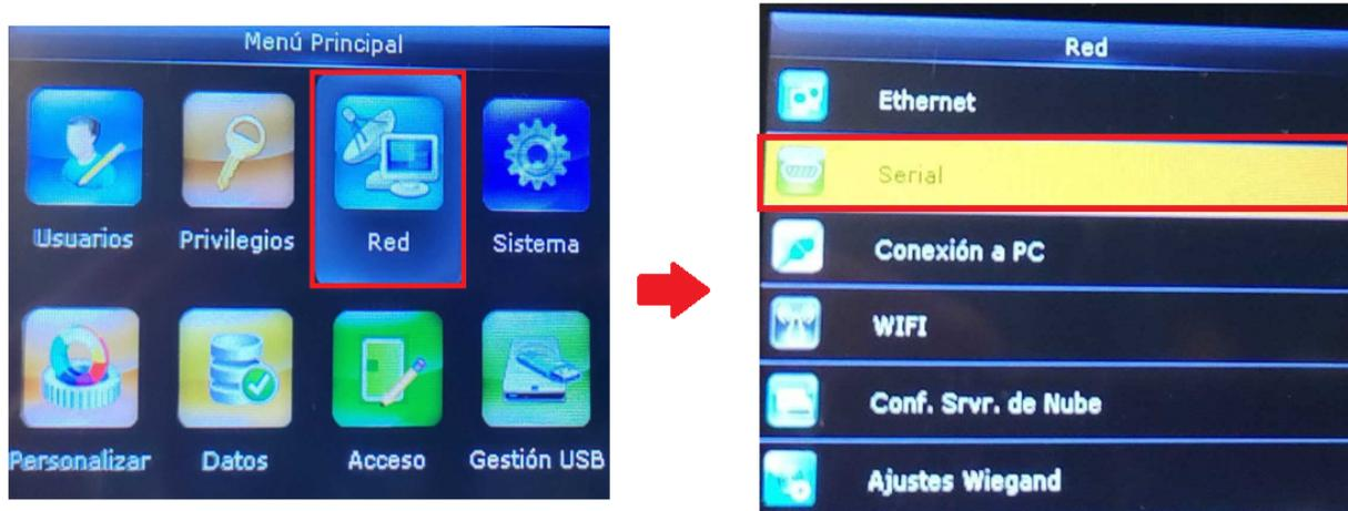
2. Por default el puerto serial viene sin uso, por lo que se deberá cambiar a equipo maestro, al hacer esto nos mostrará un mensaje indicando que el equipo se reiniciará, únicamente hay que aceptarlo,
