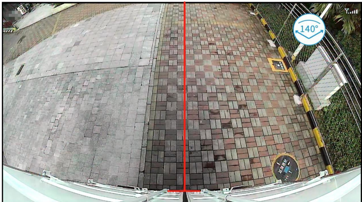
Ajuste del ángulo de la cámara. Se muestra una parte del cuerpo del vehículo en la parte inferior de la pantalla para obtener el mejor efecto de imagen.
