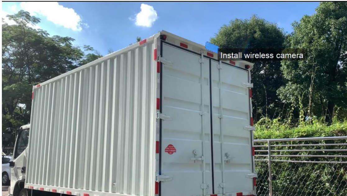
Posición recomendada de instalación de la cámara inalámbrica MCA42. Altura de instalación óptima: 2.7 m a 3 m. No debe ser inferior a 2.1 m.
