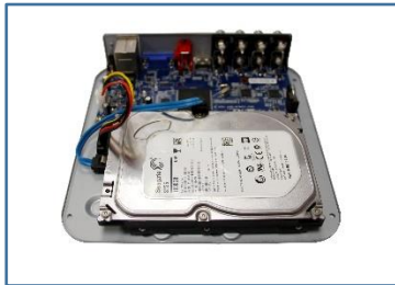
Conectar cable de Alimentación y Cable Sata.
