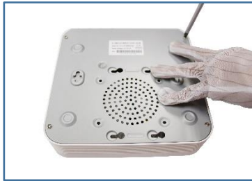
Remover la Cubierta
