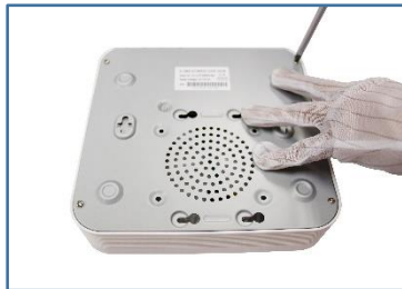
Remover la Cubierta
